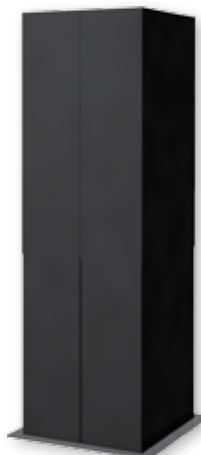
Komín je navržen tak, aby propojil horký výfuk z rozvaděče se vstupem do podhledu; jeho výška je nastavitelná od 750 do 1360mm
