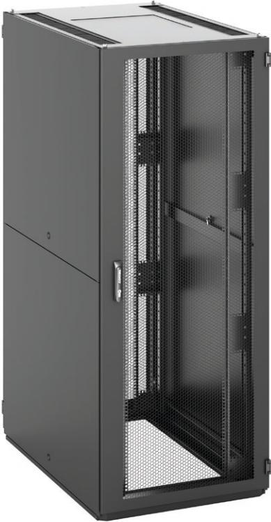
**Jednodílný horní kryt má kabelové otvory s plastovými kartáči** po obou stranách pro flexibilní instalaci kabeláže. Otvor pro ventilační jednotku je krytý plechovou záslepkou. Bočnice se závesnou konstrukcí jsou horizontálně dělené pro snadnější manipulaci a fyzicky zajištěné zámek proti neautorizovaném přístupu.
