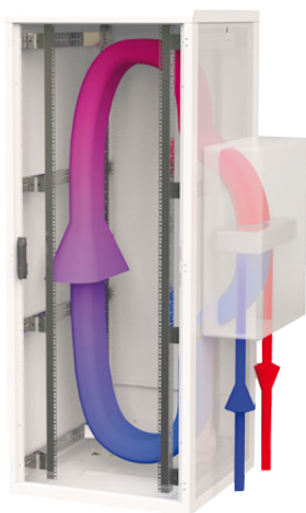
Průtok vzduchu rozvaděčem – CoolSpot CW WW verze
