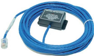
Der Flutmelder ist in der Lage, Wasser am Installationsort zu erkennen. Er verfügt über die Option einer LED-Anzeige am Gerät selbst. Maximale Kabellänge, die angeschlossen werden kann, beträgt 60 m.
