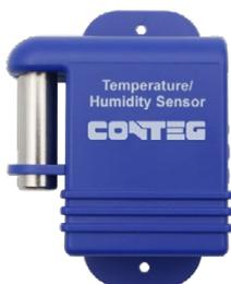
Der Temperatur- und Feuchtigkeitssensor im Gehäuse zur Platzierung im Inneren der Racks erfasst die Temperatur in einem Bereich von -55 °C bis +75 °C und die Feuchtigkeit in einem Bereich von 0-100 %. Der Sensor kann mit einem CAT 5/6 LAN-Kabel bis zu 300 m verlängert werden.
