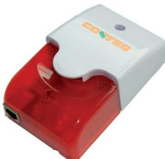
Die Hupe mit Blitzleuchte dient als optischer und akustischer Alarm für den Bediener. In einem Abstand von 1 m zum Gerät beträgt die Lautstärke bis zu 100 dB und blitzt in einem Intervall von 400x pro Minute. Das Gerät verfügt über umfangreiche Einstellungsmöglichkeiten, z.B. die Abschaltung des Alarms erst nach dem Quittieren des Eingangs der Information. Die Hupe kann mit einem CAT 5/6 LAN-Kabel bis zu 30 m verlängert werden.
