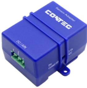
Der Adapter ermöglicht den Anschluss von externen analogen Sensoren mit 0-10 V DC Ausgangssignal. Ein Schalter an der Seite des Adapters ermöglicht das Umschalten auf einen Ein-/Ausgangskontakt, der in der Lage ist, einen 5-VDC-Ausgang zur Versorgung des Sensors aufrechtzuerhalten, während der Eingangskontakt jederzeit überwacht wird. Dieses Gerät wird an das Hauptüberwachungsgerät RAMOS Optimax angeschlossen.
