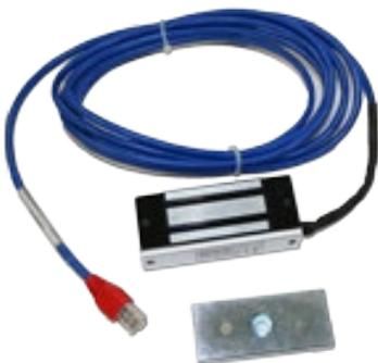
Das kleine elektromagnetische Türschloss mit einer Haltekraft von 700 N, was 70 kg entspricht, eignet sich für Racks, in denen kein elektronischer CONTEG-Griff installiert werden kann. Die LED-Schlossanzeige zeigt den Status entriegelt, verriegelt, offen oder Eindringen an. Stromversorgung vom Hauptgerät.
