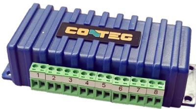
Mit dem Expander können 8 potentialfreie Ein-/Ausgänge an einem einzigen intelligenten Anschluss und Überwachungsgeräte erstellt werden. An diesen Expander kann am Eingangskontakt jede Art von Türschaltkontakt angeschlossen werden (z.B. RMS-MK-01). Das Gerät wird automatisch erkannt und vom Hauptgerät mit Strom versorgt. Der Anschluss erfolgt über ein CAT 5/6 LAN-Kabel. Maximale Länge des Verlängerungskabels beträgt 300 m.
