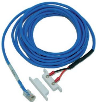
Der Magnetkontakt dient als Überwachungselement, das das Öffnen des Racks überwacht. Sowohl das unbefugte Öffnen von Türen, als auch von Seitenteilen kann überwacht werden. Die Stromversorgung des Kontakts erfolgt über das Hauptgerät. Die Verlängerung wird mit einem CAT 5/6 LAN-Kabel und einem Stecker RJ45-RJ45 (Kategorie 5e) RMS-I-CON vorgenommen. Maximale Länge des Verlängerungskabels beträgt 300 m.
