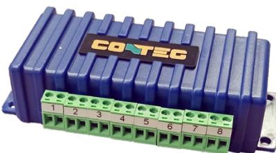
Mit dem Expander können 8 potentialfreie Ein-/Ausgänge an einem einzigen intelligenten Anschluss erstellt werden. Jeder kann als Eingang oder Ausgang (Ausgang bis zu 20 mA) eingestellt werden. An diesen Expander kann am Eingangskontakt jede Art von Türschaltkontakt angeschlossen werden.
