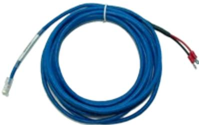
Der Eingangs-/Ausgangskontakt dient zum Anschluss externer Geräte, wie z.B. Alarm- oder Brandmeldesysteme oder beliebiger Anwendung, die eine Steuerung durch das Gerät erfordert. Bei Verwendung als Ausgang kann er bis zu 20 mA liefern. Der Eingangsspannungsbereich beträgt 0 bis 5 V. Der Kontakt wird über das Hauptgerät versorgt. Die Verlängerung wird mit einem CAT 5/6 LAN-Kabel und einem Stecker RJ45-RJ45 (Kategorie 5e) RMS-I-CON vorgenommen. Maximale Länge des Verlängerungskabels beträgt 300 m.
