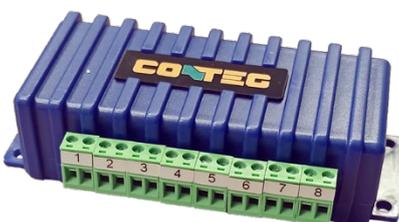
Mit dem Expander können 8 potentialfreie Ein-/Ausgänge an einem einzigen intelligenten Anschluss erstellt werden. Jeder kann als Eingang oder Ausgang (Ausgang bis 20 mA) eingestellt werden. An diesen Expander kann am Eingangskontakt jede Art von Türschaltkontakt angeschlossen werden. Die Stromversorgung des Expanders erfolgt über das Hauptgerät. Der Anschluss erfolgt über ein CAT 5/6 LAN-Kabel. Maximale Länge des Verlängerungskabels beträgt 300 m.
