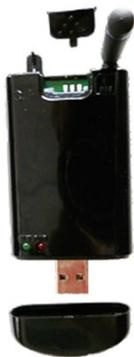
Das USB-Modem wird verwendet, um SMS-, Sprachanruf- und MMS-Benachrichtigungen direkt vom Gerät an das Mobiltelefon oder aus einer Liste von eingestellten Mobiltelefonen zu senden. Dieses Modem mit RAMOS Ultra ist eine separate Lösung und benötigt keine zusätzlichen Anwendungen.
