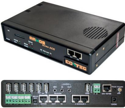
Die Hauptsteuer- und Überwachungsgerät RAMOS ULTRA ACS steuert bis zu 50 Racks mit Hilfe von Zugangsüberwachungsgeräten (RDUs), die an 2 Erweiterungsanschlüsse angeschlossen sind, und kann dank des Erweiterungsmoduls RAMOS ULTRA EX-I8 auch bis zu 500 Sensoren überwachen.
