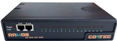
Erweiterungsmodul mit 16 optisch isolierten Eingängen. Es kann an alle Erweiterungsanschlüsse auf der Frontplatte der Basisüberwachungsgeräte RAMOS Ultra, RAMOS Ultra ACS oder RAMOS Optimax angeschlossen werden. Der Anschluss erfolgt über ein CAT5-LAN-Standardkabel.
