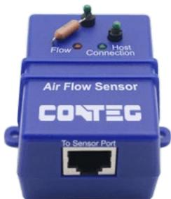
Der Sensor erkennt den vorhandenen oder fehlenden Luftstrom im Rack. Der Sensor arbeitet nach dem Prinzip der Differenzmessung, wobei der Widerstand des externen und des internen Thermistors verglichen wird. Dieses Gerät kann an eine Alarmreaktion angeschlossen werden und kann mit einem CAT 5/6 LAN-Kabel bis zu 30 m verlängert werden.
