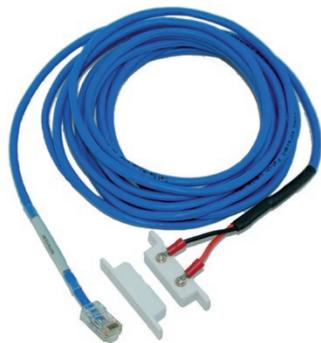
Der Magnetkontakt dient als Überwachungselement, das das Öffnen des Racks überwacht. Sowohl das unbefugte Öffnen von Türen, als auch auch von Seitenteilen kann überwacht werden. Die Stromversorgung des Kontakts erfolgt über das Hauptgerät. Die Verlängerung wird mit einem CAT 5/6 LAN-Kabel und einem Stecker RJ45-RJ45 (Kategorie 5e) RMS-I-CON vorgenommen. Maximale Länge des Verlängerungskabels beträgt 300 m.
