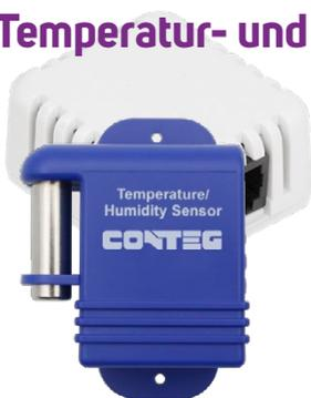
Der Temperatur- und Feuchtigkeitssensor im Gehäuse zur Platzierung im Inneren der Racks erfasst die Temperatur in einem Bereich von -55 °C bis +75 °C und die Feuchtigkeit in einem Bereich von 0-100 %. Der Sensor kann mit einem CAT 5/6 LAN-Kabel bis zu 300 m verlängert werden.
