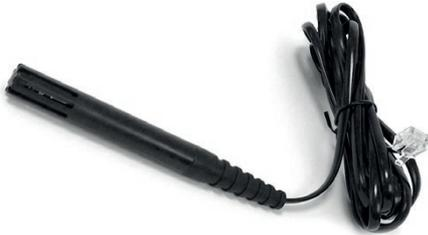
Der Sensor misst die Temperatur und Luftfeuchtigkeit im Rack. Er wird über ein 2,5 m langes Kabel direkt an die überwachte oder gesteuerte Schalttafel angeschlossen. Nach dem Anschluss des Sensors an die Zentrale (RJ12-Anschluss) wird der Sensor automatisch erkannt und die gemessenen Umgebungsparameter sind auf dem Webserver und über SNMP verfügbar. Schwarze Farbe.
