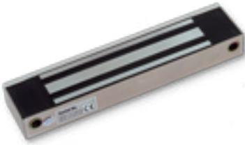
Das wasserdichte elektromagnetische Türschloss mit einer Haltekraft von 3500 N, was 350 kg entspricht, eignet sich für den Einbau an Eingangstüren. Die LED-Schlossanzeige zeigt den Status entriegelt, verriegelt, offen oder Eindringen an. Stromversorgung vom Hauptgerät.
