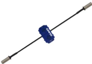
Sensoren für Mapping der Racks sind ideal für die vollständige Überwachung der Umgebung in Racks. Mit Hilfe von Sensoren können Hotspots definiert und die IT-Hardware im Rack oder die Leistung des Kühlgeräts angepasst werden. Vorverdrahtete Sensoren in einer Kabelleitung messen auf 3 Ebenen. Sie ermöglichen die Überwachung der Temperatur oben, in der Mitte und unten an der Vorder- oder Rückseite der Racks sowie der Temperaturdifferenz auf jeder Ebene ( $\Delta T$ -Wert).
