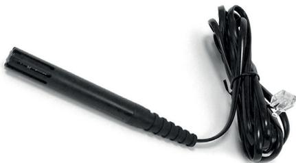
Le capteur lit la température et l'humidité à l'intérieur de la baie. Il se connecte via un câble de 2,5 m directement au PDU monitoré ou managé. Une fois que le capteur est connecté au PDU (connecteur RJ12), le capteur est automatiquement détecté et les paramètres mesurés sont disponibles via un site web ou SNMP. Couleur : noir
