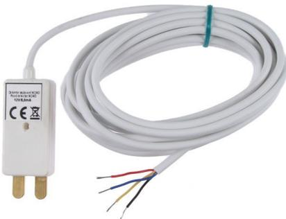
Le détecteur d'eau est utilisé pour signaler une inondation susceptible de mettre en péril le fonctionnement de l'équipement. La détection s'effectue au niveau des électrodes du détecteur, le facteur déterminant étant l'eau qui relie les électrodes.
