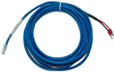
Le contact sec est utilisé pour connecter des appareils externes, comme des systèmes de sécurité ou incendie, ou bien toute application nécessitant un contrôle par l'unité. Quand il est utilisé comme une sortie, il peut fournir jusqu'à 20 mA. La plage d'alimentation d'entrée est de 0 à 5V. Le contact est alimenté par l'unité principale. L'extension est réalisée en utilisant un câble réseau CAT 5/6 standard et un coupleur RJ45-RJ45 RMS-I-CON.
