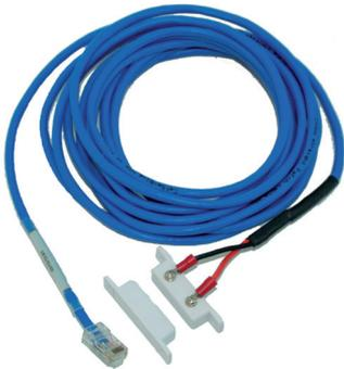
Le contact de porte magnétique est une fonction de sécurité la surveillance des portes et panneaux latéraux. Avec le contact de porte magnétique, il est possible de surveiller une ouverture des portes non autorisée ainsi que les panneaux latéraux. Le contact est alimenté par l'unité principale. L'extension est réalisée en utilisant un câble réseau CAT 5/6 standard et un coupleur RJ45-RJ45 (catégorie 5E) RMS-I-CON. La longueur maximum du câble d'extension est de 300 m.
