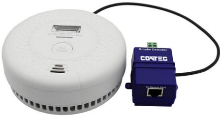
Le détecteur émet un signal d'alarme à 2 états de 85 dB à une distance de 3 m de l'unité et est également équipé d'une indication LED. Il doit être monté au plafond pour une détection maximale de la fumée. Cet appareil est alimenté par l'unité principale et peut être connecté à une batterie de secours de 9V. Il est connecté en utilisant un câble LAN CAT 5/6 standard avec une longueur maximum de connexion de 90 m.
