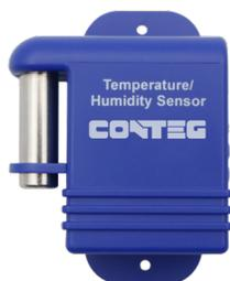
Le capteur de température et humidité est conçu pour être placé à l'intérieur des baies et mesurer la température dans la plage de  $-55^{\circ}\text{C}$  à  $+75^{\circ}\text{C}$  et l'humidité dans la plage de 0 à 100 %. Le capteur peut être étendu pour atteindre jusqu'à 300 m en utilisant un câble LAN CAT 5/6.
