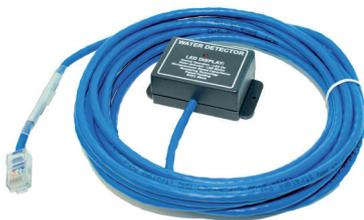
Le capteur d'eau localisé est capable de détecter l'eau sur le site d'installation. Il a la possibilité d'indication LED sur l'appareil en lui-même. L'extension est faite en utilisant un câble LAN CAT 5/6 standard. La longueur maximum du câble d'extension est de 60 m.
