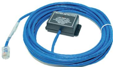
Le serpentín détecteur d'eau est capable de détecter l'eau sur le site d'installation. Il offre la possibilité d'une indication par LED sur le dispositif lui-même. L'extension se fait à l'aide d'un câble LAN standard CAT 5/6. La longueur maximale du câble longueur maximale d'extension du câble est de 60 m.
