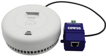
Le détecteur émet un signal d'alarme à 2 états de 85 dB à une distance de 3 m de l'unité et est également équipé d'une indication LED. Il doit être monté au plafond pour une détection maximale de la fumée. Cet appareil est alimenté par l'unité principale et peut être connecté à une batterie de secours de 9 V. Il est connecté en utilisant un câble LAN CAT 5/6 standard avec une longueur maximum de connexion de 90 m.
