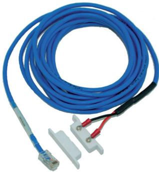
Le contact de porte magnétique est une fonction de sécurité la surveillance des portes et panneaux latéraux. Avec le contact de porte magnétique, il est possible de surveiller une ouverture des portes non autorisée ainsi que les panneaux latéraux. Le contact est alimenté par l'unité principale. L'extension est réalisée en utilisant un câble réseau CAT 5/6 standard et un coupleur RJ45-RJ45 (catégorie 5E) RMS-I-CON. La longueur maximum du câble d'extension est de 300 m.
