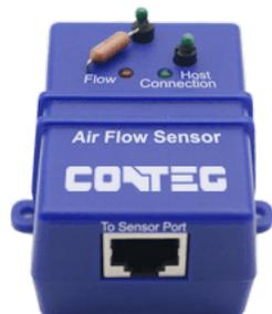
Le capteur détecte la présence ou l'absence de flux d'air à l'intérieur des baies. Le capteur fonctionne sur le principe de la mesure différentielle, qui compare la résistance de la thermistance interne et externe. Ce dispositif peut être connecté à une réponse d'alarme et peut être étendu jusqu'à 30 m en utilisant un réseau LAN CAT 5/6.
