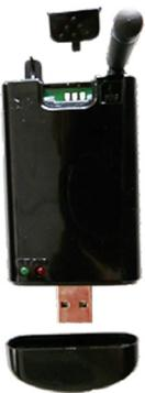
Le modem USB peut être utilisé pour envoyer des SMS, des appels vocaux et des alertes MMS directement depuis l'unité principale vers un téléphone mobile ou vers une liste de téléphones mobiles. Ce modem RAMOS Ultra est une solution autonome et ne nécessite pas d'application tierce.
