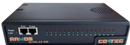
Un module d'extension qui possède 16 ports et qui est connecté à n'importe quel port d'extension situés sur la face avant des unités de surveillance principales RAMOS ULTRA, RAMOS ULTRA ACS, RAMOS Optimax. Ils sont connectés à l'aide d'un câble LAN standard CAT5.
