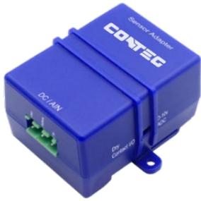
L'adaptateur de capteur rend facile la connexion d'un capteur analogique tiers avec une sortie 0-10 V DC. Un interrupteur sur le côté du capteur vous permet de changer un contact sec I/O à la place, qui est capable de maintenir une sortie 5V DC pour alimenter le capteur tout le temps, tout en surveillant encore l'entrée du contact sec. Cet appareil est pluggé aux unités principales de monitoring Optimax.
