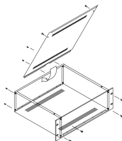
➤ Boîtiers pour sous-racks et 19" **Serie 180** destinés aux équipements électroniques et de télécommunication qui peuvent être installés dans des racks 19". Construite selon la norme IEC 297-2 (DIN 41 494). Son assemblage facile, son accessibilité optimale et sa construction solide permettent une installation efficace de l'équipement dans le baie. Permet le montage dans un baie 19" avec des guides télescopiques standard (100% d'extension).
