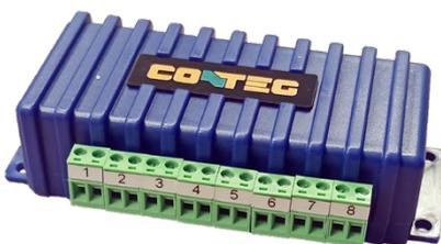
Le module d'extension permet de créer 8 entrées/sorties sur un seul port intelligent de l'unité principale. Chaque port peut être configuré comme une entrée ou une sortie (sortie jusqu'à 20 mA). Le contact d'entrée du module d'extension est capable de supporter tout type de contact de porte. Le dispositif est automatiquement reconnu et alimenté par l'unité principale. Le module est connecté à l'aide d'un câble LAN standard CAT 5/6. La longueur maximale du câble est de 300 m.
