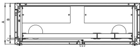
➤ La baie télécoms **OPTIMAL** est conçue pour supporter soit une configuration interconnectée horizontale, soit une topologie Point de Consolidation basée sur les normes ISO/IEC 11 801, TIA-942 et TIA-568 B. Cette solution est recommandée pour les salles de télécommunications où il faut séparer les équipements actifs et les panneaux de brassage.
