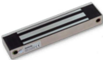
Cette serrure électromagnétique étanche avec une force de maintien de 3500N, qui correspond à 350kg, est adaptée pour un montage sur des portes d'entrée. La LED indique l'état de la serrure : déverrouillée, verrouillée, ouverte ou violation. Alimentée par l'unité principale.
