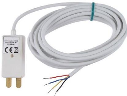
Le détecteur d'eau est utilisé pour signaler une inondation susceptible de mettre en péril le fonctionnement de l'équipement. La détection s'effectue au niveau des électrodes du détecteur, le facteur déterminant étant l'eau qui relie les électrodes.
