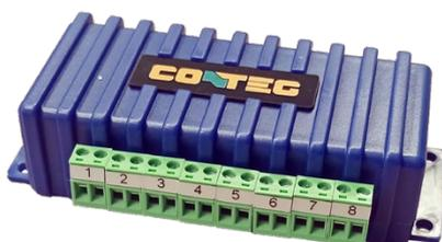
L'extension permet de créer 8 entrées/sorties sur un simple port intelligent de l'unité principale. Chaque port peut être paramétré comme une entrée ou une sortie (sortie jusqu'à 20mA). Le contact d'entrée de l'extension est capable de supporter n'importe quel type de contact de porte. L'appareil est automatiquement reconnu et alimenté par l'unité principale. L'extension est connectée en utilisant un câble LAN CAT 5/6 standard. La longueur maximum du câble d'extension est de 300 m.
