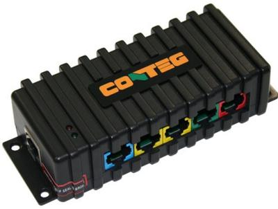
Les RDUs sont connectés en daisy chain aux unités de contrôle et supervision via les ports d'extension. Chaque RDU peut être connecté à un lecteur et une serrure ou deux poignées via un hub
