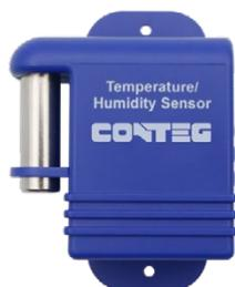
Le capteur de température et humidité compact est conçu pour un placement à l'intérieur des baies et mesure la température dans une plage de -55°C à +75°C et l'humidité dans une plage de 0-100%. Le capteur peut être étendu pour atteindre jusqu'à 300m en utilisant un câble LAN Cat5/6.
