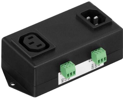
La PowerBox est conçue pour détecter et contrôler la tension 110/230VAC en l'allumant ou en l'éteignant. La PowerBox peut être contrôlée aussi bien en tension qu'en absence de tension. Elle convient au redémarrage à distance des serveurs, à la commande d'un refroidissement ou d'un ventilateur supplémentaire et à de nombreuses autres fonctions.
