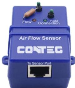
La capteur détecte la présence ou l'absence de débit d'air à l'intérieur des baies. La capteur fonctionne sur le principe de mesure différentielle, qui compare la résistance de la thermistance externe et interne. Cet appareil peut être connecté à une réponse d'alarme et peut être étendu jusqu'à 30 m en utilisant un câble LAN CAT 5/6.
