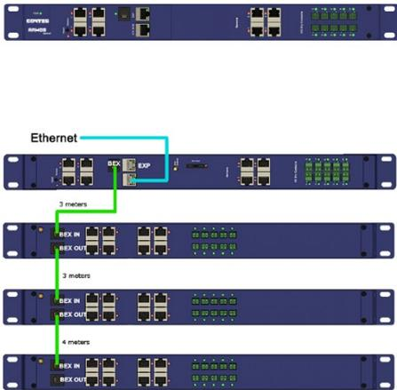
L'unité de supervision principale fournit une surveillance à distance de l'environnement protégé dans de plus petites salles serveur utilisant des capteurs installés mesurant la température, l'humidité, la détection d'intrusion, la présence de gaz ou produits chimiques nocifs, ou d'autres conditions dangereuses potentielles.
