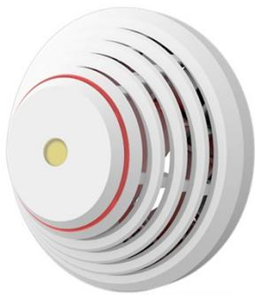
Détecteur de fumée optique avec sortie relais et double détection - optique et température, équipé d'une sirène pour une alerte locale avec un volume d'au moins 85 db à une distance de 3 m de l'appareil.
