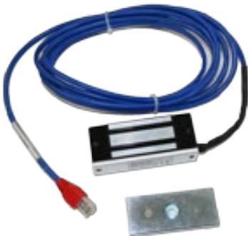
Cette serrure de porte électromagnétique courte avec une force de maintien de 700N, qui correspond à 70kg, est adaptée pour les baies qui ne peuvent pas être équipées avec une poignée électronique CONTEG. La LED indique l'état de la fermeture : déverrouillée, verrouillée, ouverte ou violation. Alimentée par l'unité principale.
